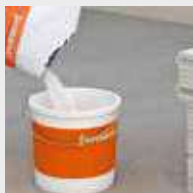
10 pav.: Įberkite fermacell siūlių užpildo į vandenį
