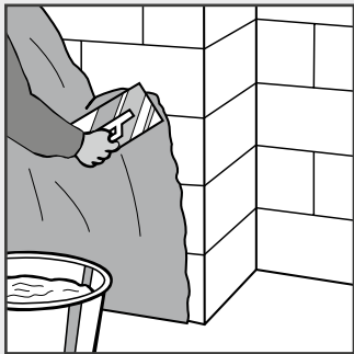
18 pav. Kamino sienos padengiamos klijų mišinio sluoksniu ir tvirtinamos fermacell plokštės
